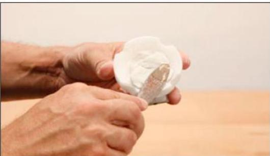
1-11. 石膏モデル遠位端に開けた穴(1-8.)と、その周辺にも石膏を塗る
