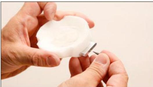
1-8. モデルの遠位端に、6mm径のドリルで2.5cmほどの深さの穴を開ける
